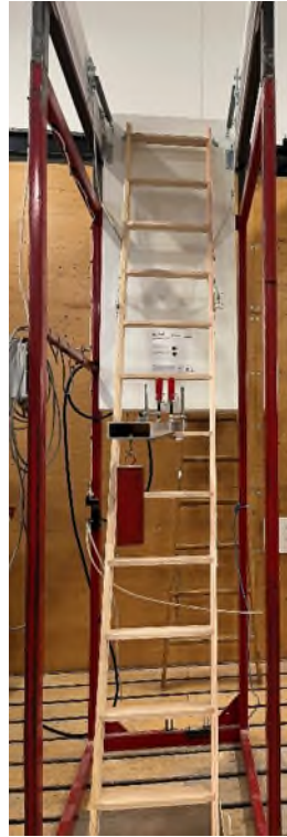
Figure 3: Torsion test setup / Torsionsversuchsaufbau
