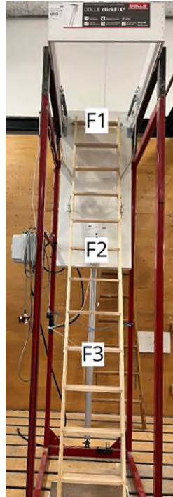
Figure 2: Points for static load test / Belastungspunkte für den statischen Versuch
